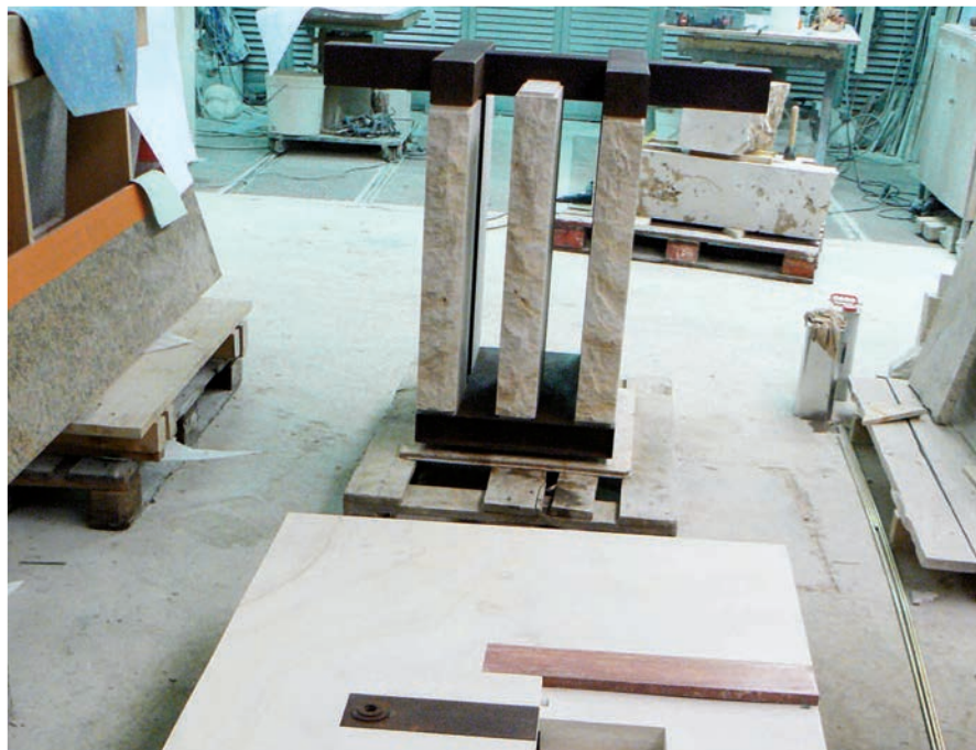
Le pied de l'autel et le plateau avant d'être assemblés dans l'atelier. Le pied de l'autel est une ossature en acier brûni qui est habillée de pierre de Beaunotte.
